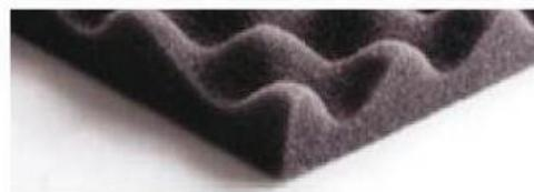
Resina di poliuretano espanso celle aperte a base poliestere tipo autoestinguente AUHF1. Con profilatura bugnata. Si può adesivizzare con adesivo acrilico base acqua, non tossico, su liner di polipropilene per superfici pulite o adesivi acrilici modificati per applicazioni più critiche.
