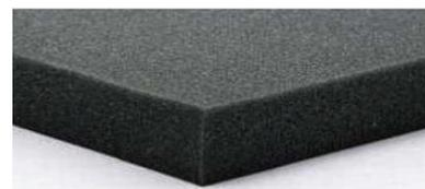
Resina di poliuretano espanso celle aperte a base poliestere tipo autoestinguente AUHF1.
